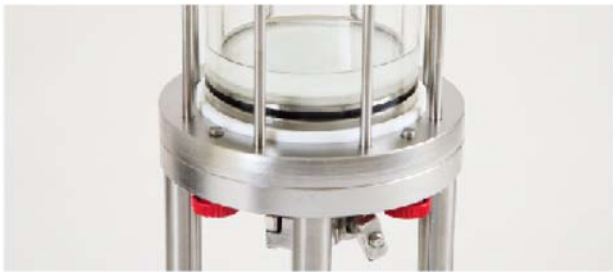
图 6: 无气泡, 覆盖液体的底部筛板
